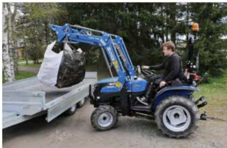
↑ Etukuormaimen nostokorkeus riittää esimerkiksi polttopuusäkkien kuormaukseen auton perävaunulle. Maata voi kuormata myös matalempiin traktorin maansiirtovaunuihin.
