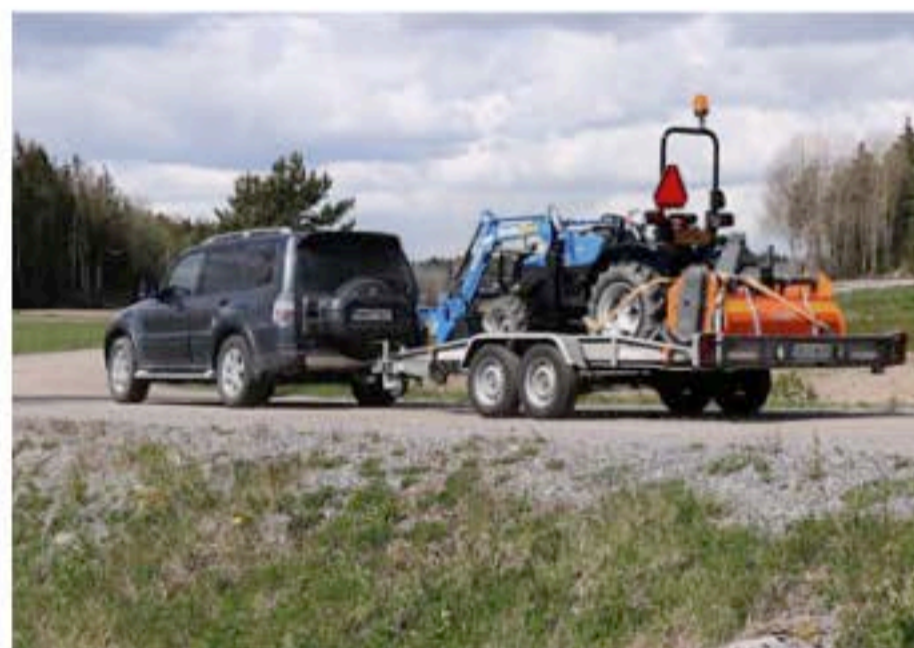
↑ Traktori painaa noin 1 300 kg, minkä vuoksi sitä voidaan kuljettaa henkilöauton perävaunulla.
