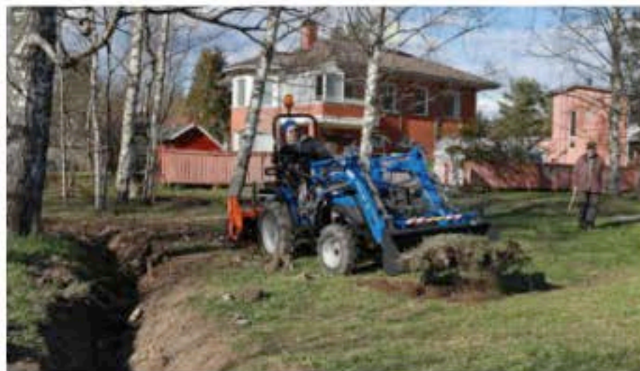
↑ Etukuormaaja on näppärä apu monessa työssä, aivan kuin isomman traktorin kanssa. Soliksen kanssa on oltava kasaan puskiessa tarkkana, sillä nostovoimaa ei ole tarjolla ylen määrin. Sopivia siljuja kuorien tälläkin kuormaajalla pärjää hyvin.
